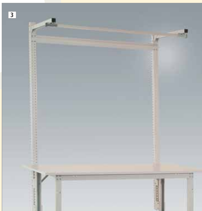
Aus Profilstahl 60 x 55 mm, Befestigung an Tischgestell hinten, Zubehörkomponenten im Raster von 30 mm höheneinstellbar, Tragkraft 40 kg bei Tiefe 350 mm, Tragkraft 25 kg bei Tiefe 700 mm, Nutzhöhe über Tisch 1500 mm.
